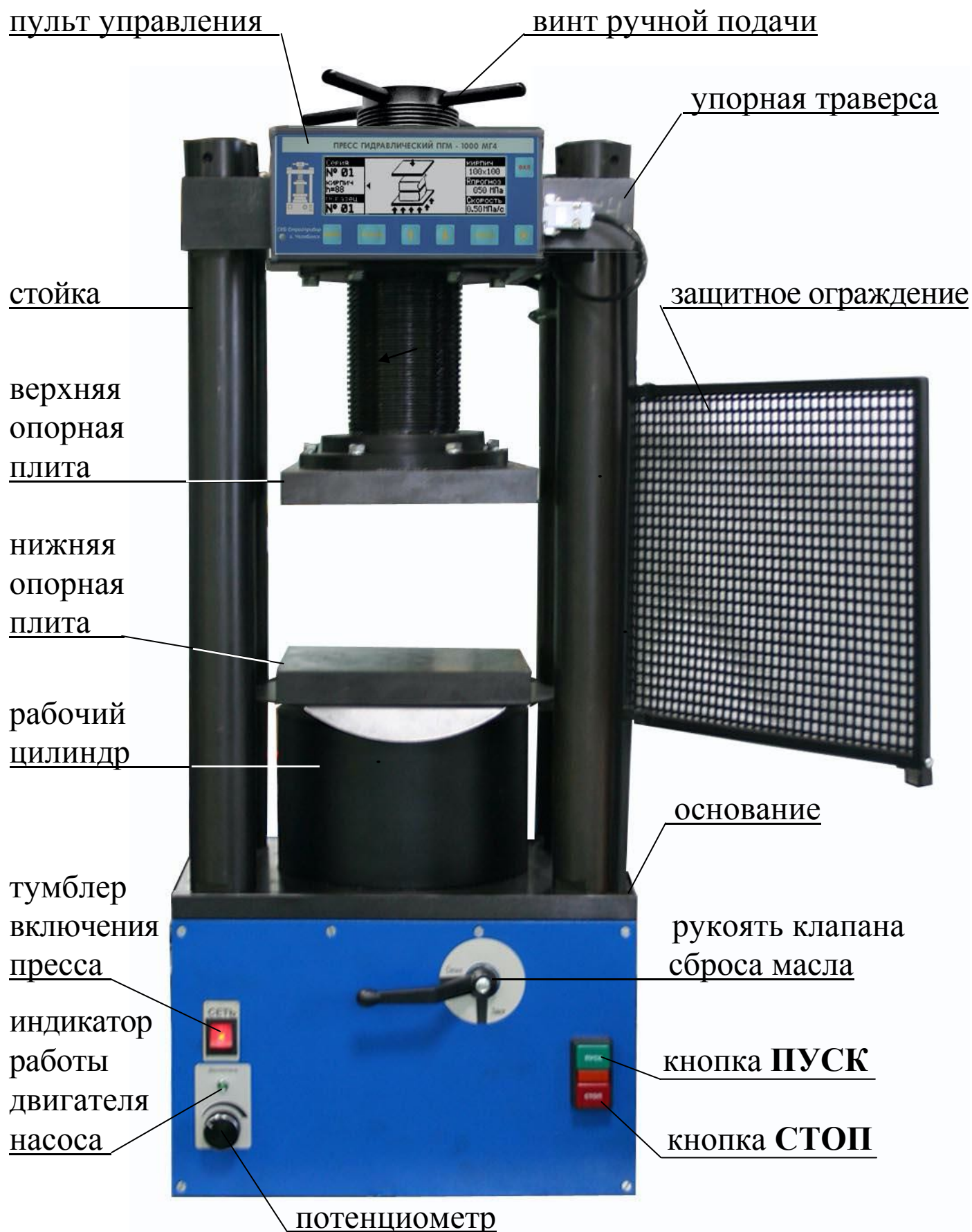
Рисунок 1.а – Внешний вид пресса. Вид спереди
